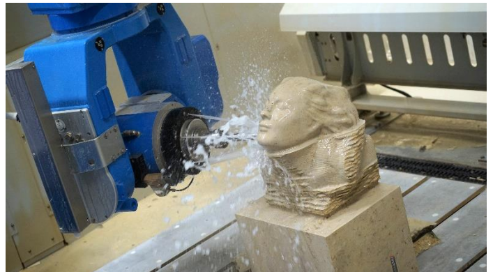
Abb. 2: Hauseigenes 5-Achs-Bearbeitungszentrum im Einsatz
