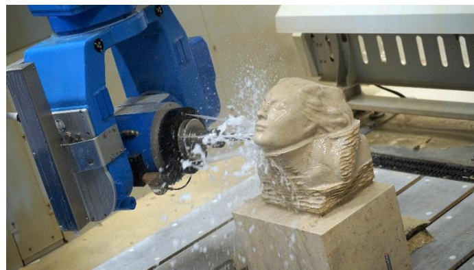
Abb. 2: Hauseigenes 5-Achs-Bearbeitungszentrum im Einsatz
